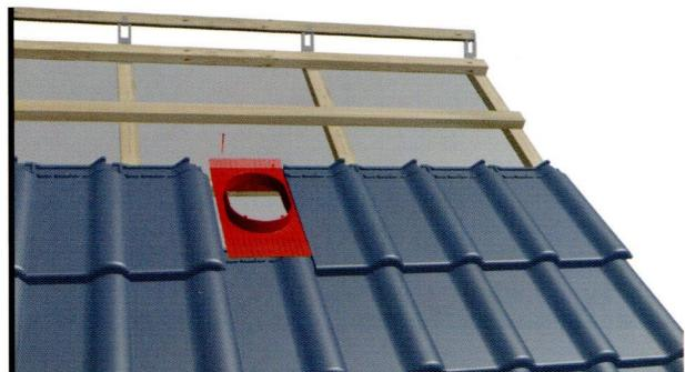
Spodnú časť podstavca (konzoly) priskrutkujte k late pomocou troch dlhších skrutiek (dva zhora, jeden od čelnej strany laty). V prípad potreby je možné dodatočne upevniť spodný podstavec k late (nižší riadok škridiel) pomocou drôtu z nehrdz. ocele, k špeciálne profilovaným výstupom vo vnútri konzoly.
