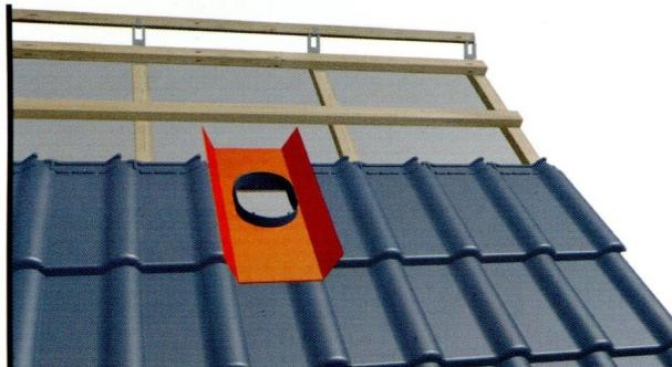
Neodstraňujúc preložku zabezpečujúcu butylové lepidlo predbežne prispôsobiť prírubu UNI k strešnej krytine a v pripade potreby skratiť prírubu. Odstrániť preložku z prírubi UNI a tesne ju prilepiť do konzoly. Pozor - v tejto fázi montáže nelepíme prírubu k strešnej krytine.
